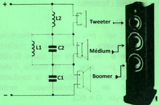
Pour sélectionner la bande fréquentielle adaptée à chaque haut-parleur, trois types de filtres électriques peuvent être utilisés :
