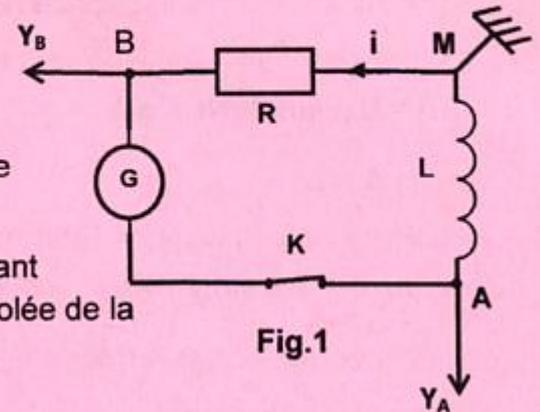
Les voies  $Y_A$  et  $Y_B$  représentent les entrées d'un oscilloscope, M représente la masse.
